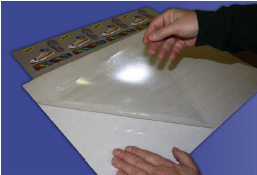
**Paso 3.** Colocar el TTD Easy Mask sobre una superficie plana y con el adhesivo hacia arriba.
